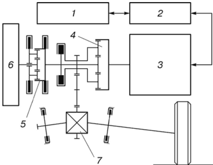
**Рис. 1.** Схема гибридного силового агрегата с маховиным накопителем и электромеханическим приводом фирмы "BMW" (Германия):
