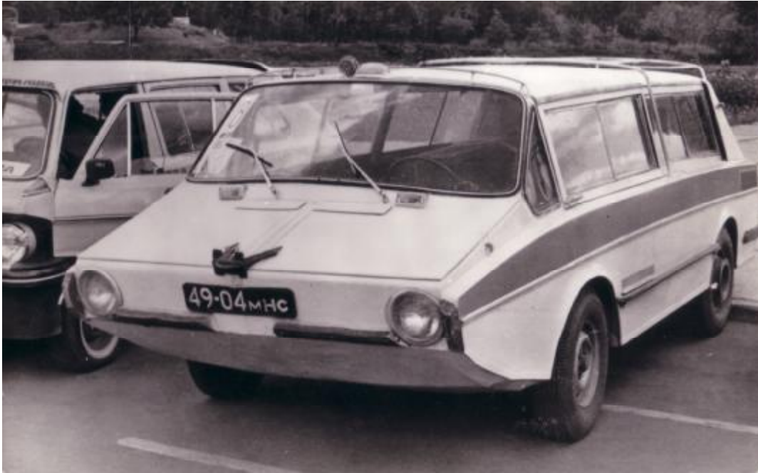
Амфибия «Ихтиандр» (Москва) Автор И.Рикман, фото О.Яременко Особенность конструкции: Кузов дюралевый, компоновка – заднемоторная, двигатель ВАЗ-2101, движитель водометный, мест – 5, масса в снаряженном состоянии – 1100 кг, скорость – 130 км/час, по воде – 18 км/час, расход топлива по шоссе составляет 10-11 л/на 100 км, длина 4000 мм, ширина – 1800 мм, высота 1500 мм.
