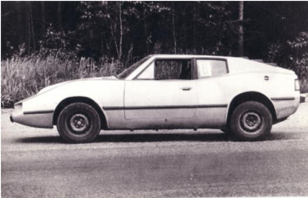
Спортивный автомобиль «Сайгак» (Москва) Автор Г.Власьев, фото О.Яременко Особенность конструкции: Спортивный автомобиль для ралли и туризма, во время соревнований Предусмотрена установка дополнительных пружин и амортизаторов. Компановка – классическая. Мест – 2, кузов из стеклопластика, двигатель – ВАЗ 2101, масса в снаряженном состоянии – 1000 кг, скорость – 140 км/час, расход топлива по шоссе составляет 8-10 л/на 100 км.
