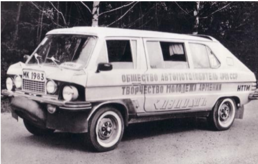
Автомобиль «Лаура» (г.Ленинград) Авторы Д.Парфенов и Г.Хаинов , фото И.Туревского Компановка – переднеприводная, мест – 5, кузов-купе из стеклоглани и полистирола, двигатель – ВАЗ 2105, коробка передач от ЗАЗ-968 (переделанная), передняя подвеска мак-ферсон,масса в снаряженном состоянии -1000 кг, скорость – 160 км/час, расход топлива по шоссе составляет 6 л/на 100 км при скорости 90 км/час.
