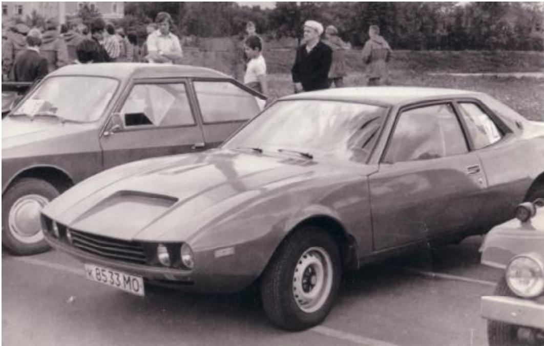
Автомобиль молодежный «Ласка» (г.Москва) Автор В.Мищенко, фото О.Яременко Компановка – классическая, мест – 2+2, кузов из стеклопластика ,купе, двигатель – ВАЗ 2103, масса в снаряженном состоянии – 950 кг, скорость – 165 км/час, расход топлива по шоссе составляет 8,5 л/на 100 км
