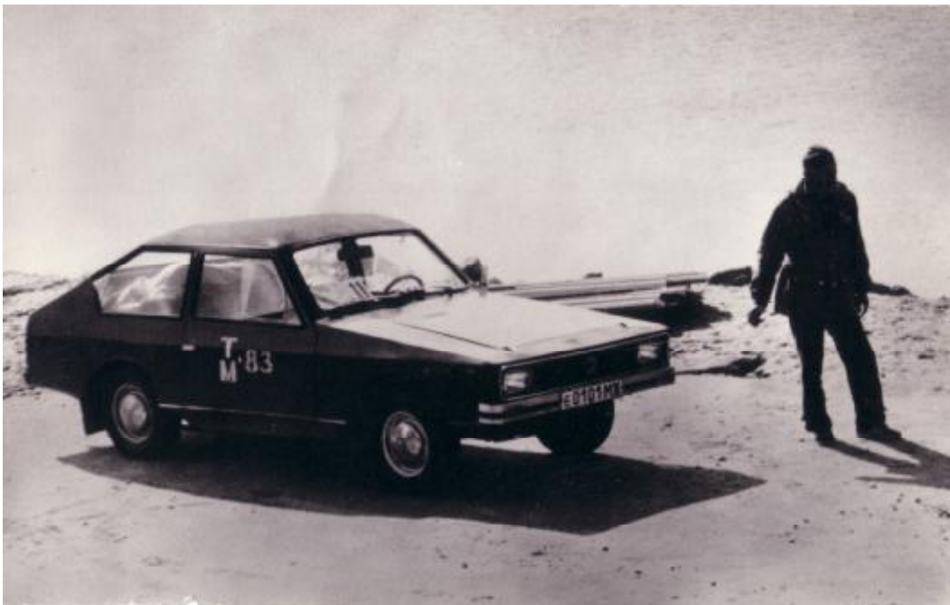
Экспериментальный автомобиль «Бычок» (г.Подольск) Автор В.Миронов, фото О.Яременко Особенность конструкции: бесступенчатая автоматическая клиноременная передача с центробежным регулятором, заменившая сцепление, коробку передач, карданный вал и главную передачу. Мест – 4, кузов - купе, двигатель – ВАЗ 2103, масса в снаряженном состоянии – 850 кг, скорость – 120 км/час, расход топлива по шоссе составляет 8,5 л/на 100 км. Автомобиль можно вести за собой, привязав веревку к приводу дроссельной заслонки. Это обеспечивается автоматическим включением трансмиссии с помощью центробежного регулятора.
