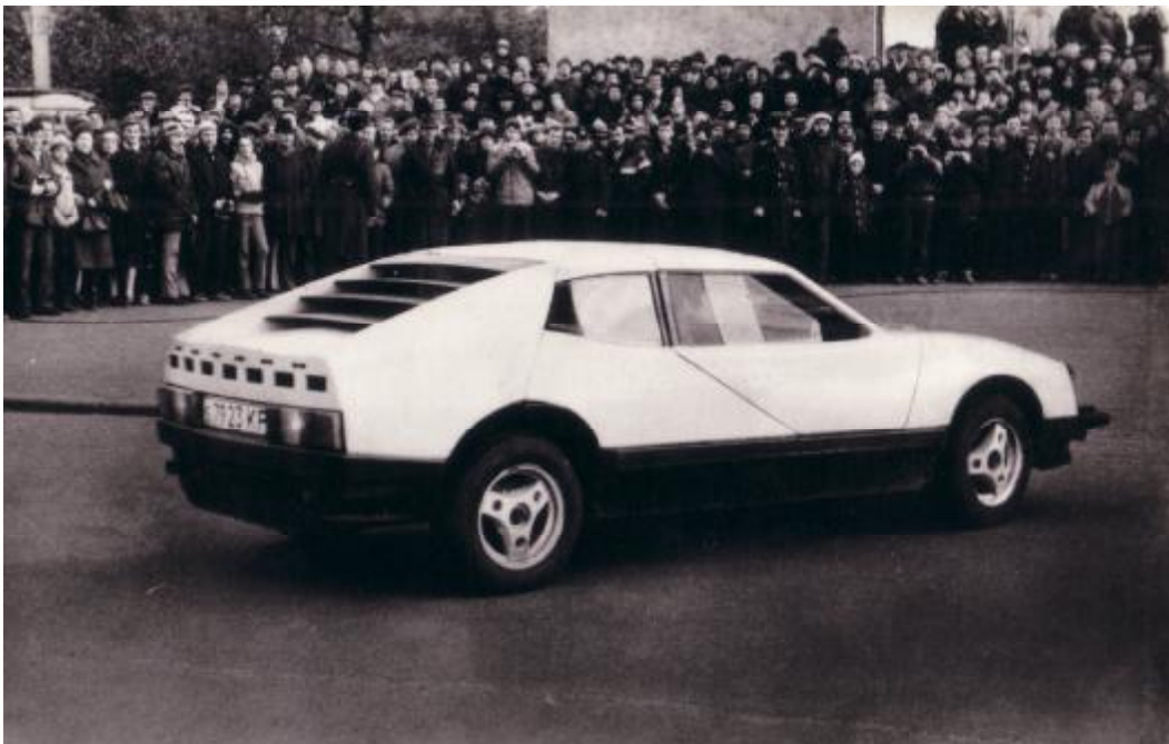
Автомобиль для туризма «Катран» (г.Севастополь) Автор А.Федотов, фото И.Туревского Компановка – классическая, мест – 2, кузов из стеклопластика с откидывающимся в перед фонарем, низ металлический, двигатель – ВАЗ 2101, масса в снаряженном состоянии – 900 кг, скорость – 160 км/час, расход топлива по шоссе составляет 7-9 л/на 100 км
