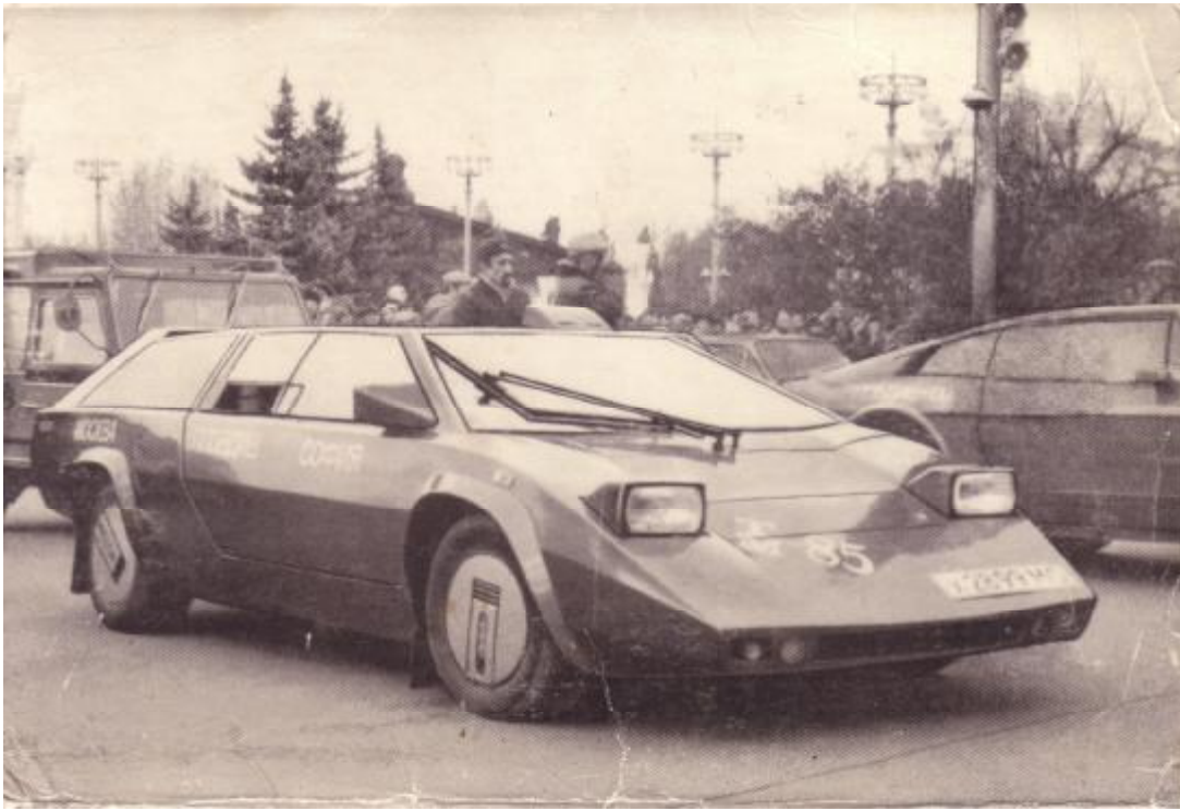
Автомобиль «Пангалина» (г.Ухта) Автор А.Кулыгин, фото И.Туревского Компановка – классическая, мест – 2, кузов из стеклопластика с откидывающимся в перед фонарем (с помощью электропривода), двигатель – ВАЗ 2101, низкопрофильные шины, масса в снаряженном состоянии – 1000 кг, скорость – 160 км/час, расход топлива при скорости 90 км/час составляет 7,5 л/на 100 км.
