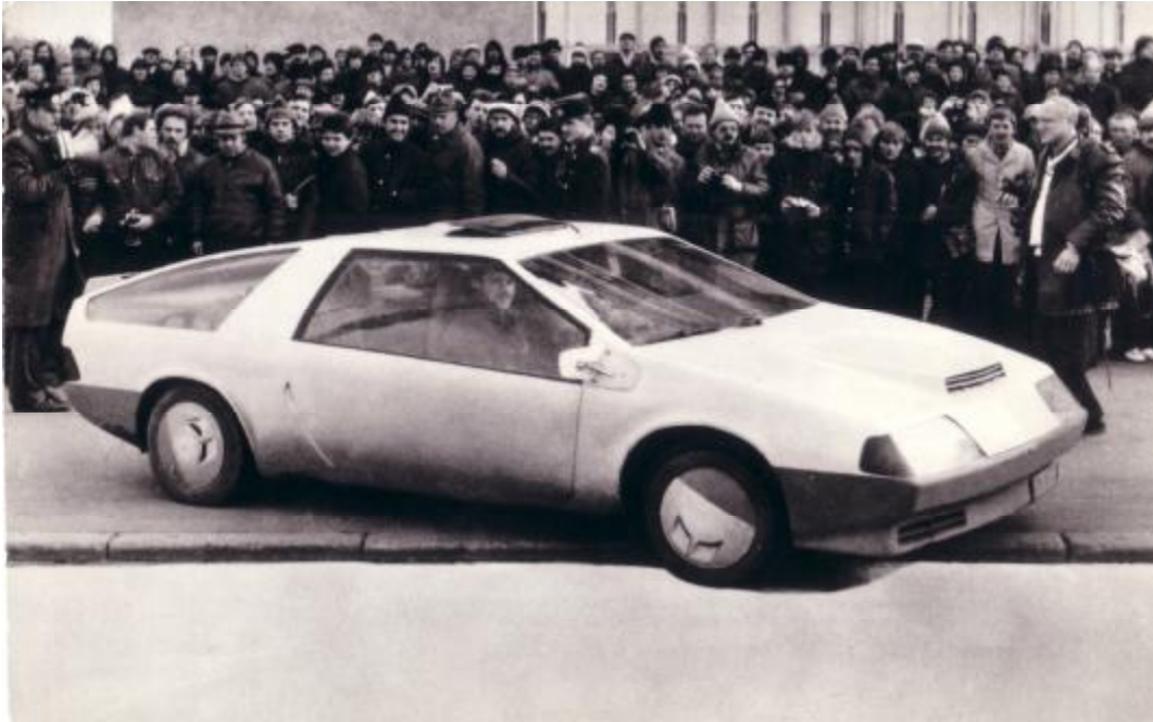
Автомобиль «Лаура» (г.Ленинград) Авторы Д.Парфенов и Г.Хаинов , фото И.Туревского Компановка – переднеприводная, мест – 5, кузов-купе из стеклоглани и полистирола, двигатель – ВАЗ 2105, коробка передач от ЗАЗ-968 (переделанная), передняя подвеска мак-ферсон,масса в снаряженном состоянии -1000 кг, скорость – 160 км/час, расход топлива по шоссе составляет 6 л/на 100 км при скорости 90 км/час.
